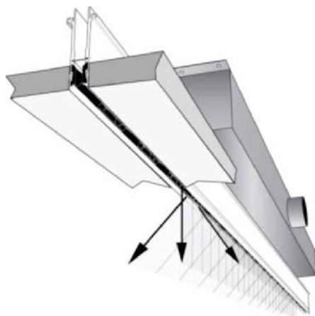
Schema liniového difusoru zabudovaného do stropu
